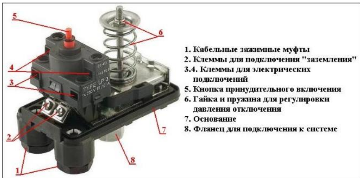
Основные элементы реле «сухого хода»
